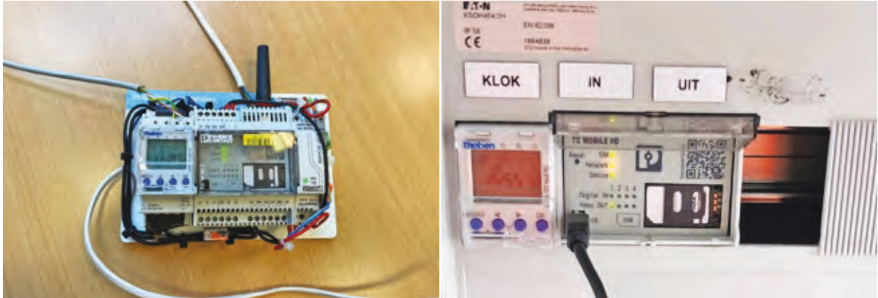
Links de testopstelling van gsm-relais en schakelklok. Rechts de ingebouwde relais en klok op station Arnhem Velperpoort.
